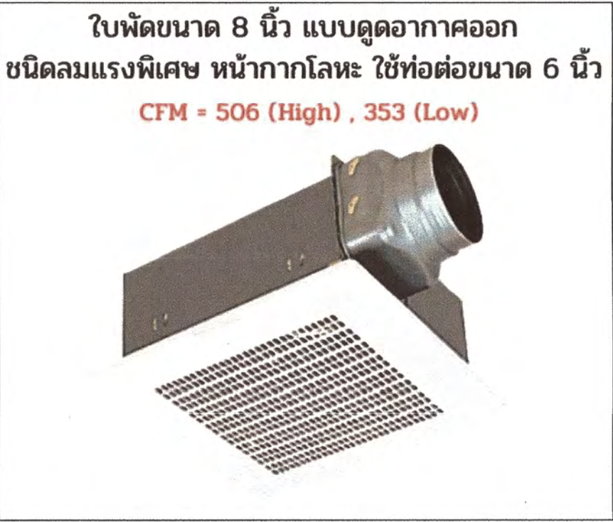
พัดลมระบายอากาศฝังฝ้าเพดานพัดลมขนาด 8 นิ้วแบบดูดท่อฝังฝ้าใช้ท่อต่อขนาด 6 นิ้ว ชนิดลมแรงพิเศษ 220V. 125W. หน้ากากโลหะทำสีดำด้าน/ ปริมาณลม (ลบ ฟ./นาท) 506 (High), 353(Low) พ่วงกับสวิทช์เครื่องปรับอากาศห้องอาหาร ทำงานเปิด-ปิด พร้อมกับเครื่องปรับอากาศ
